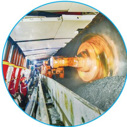
图为山东能源金鸡滩煤矿世界首套8.2米超大采高智能化综采面。 山东能源集团/供图
