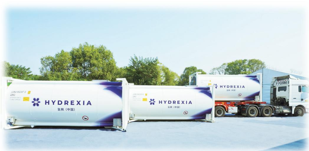
图为氢枫(中国)研发的镁基固态储氢罐。氢枫(中国)/供图
