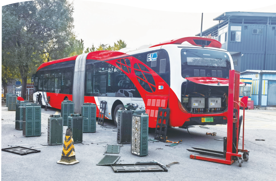
一辆正在更换动力电池电芯的纯电动城市客车。
