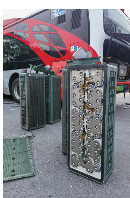
一辆正在更换动力电池电芯的纯电动城市客车。
