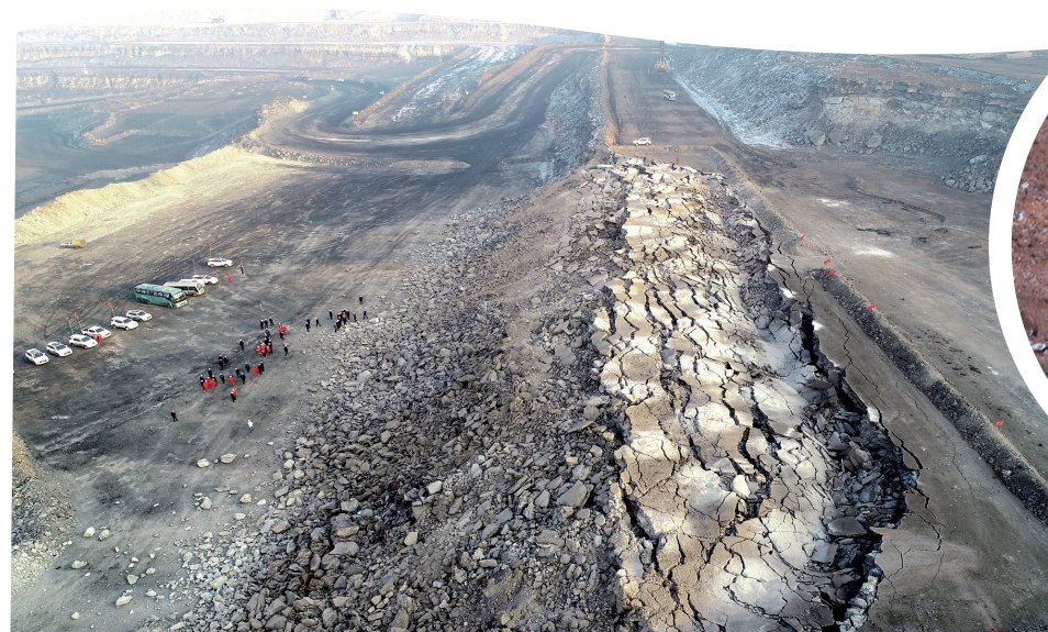
▲图为准能集团在哈尔乌素露天煤矿煤基纳米碳氢硝铵炸药岩石松动爆破对比试验现场。王浩淼/摄
