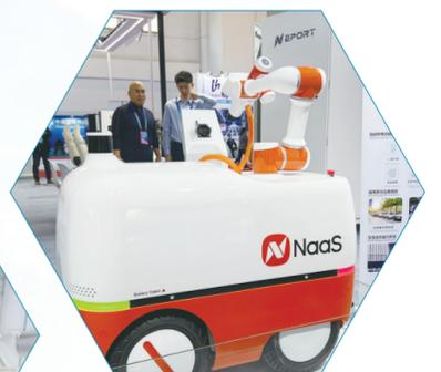
能链智电展出的自动充电机器人。
