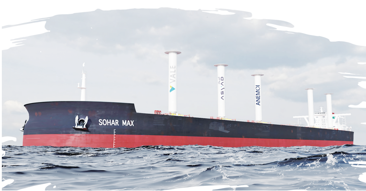
安装了风力驱动转子系统的货船。
