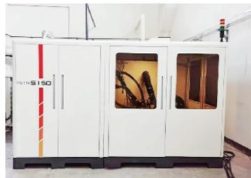
图为科威尔 FCTS-S 系列燃料电池电堆测试系统。
