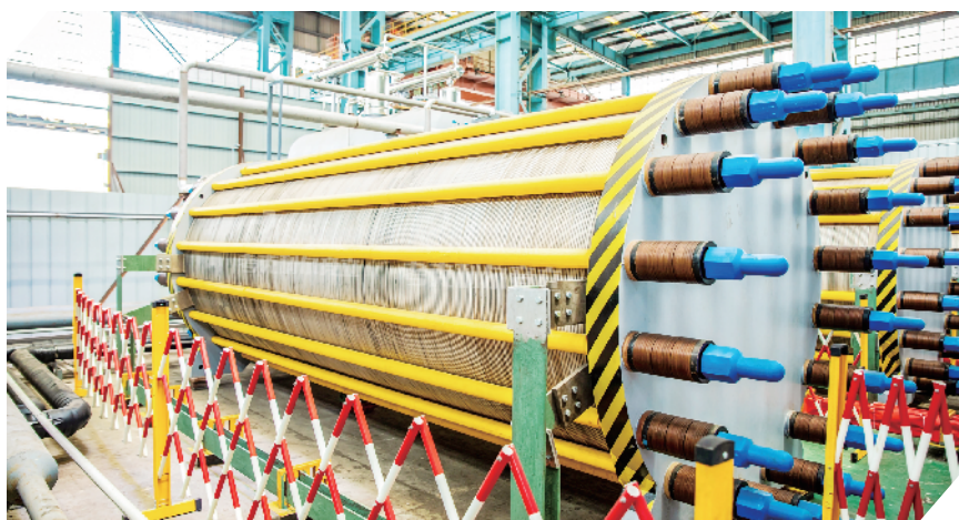
图为考克利尔克立向中石化新疆库车绿氢项目提供的1000Nm 3 /h碱性电解槽。考克利尔克立/供图
