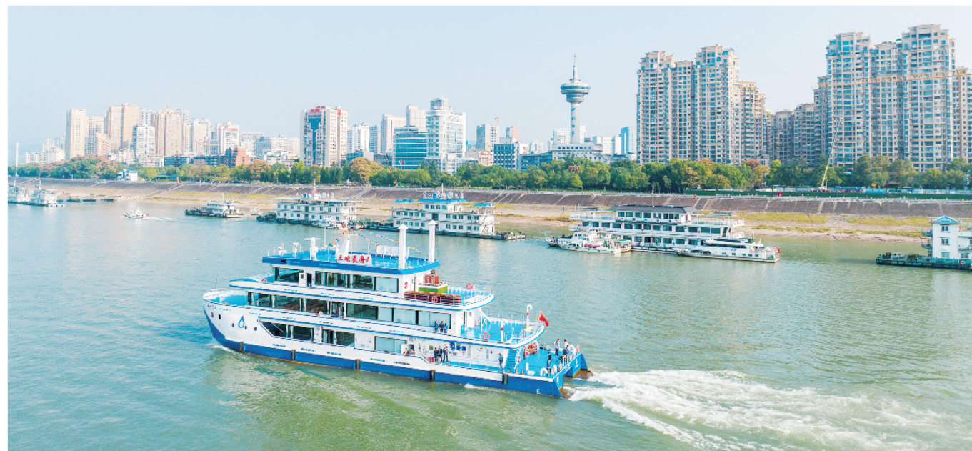
10月11日,氢燃料电池动力示范船“三峡氢舟1”号在湖北宜昌三峡游客中心(九码头)完成首航。该示范船为铝铜复合结构,总长49.9米、型宽10.4米、型深3.2米,氢燃料电池额定输出功率为500千瓦,续航里程可达200公里。 人民图片
