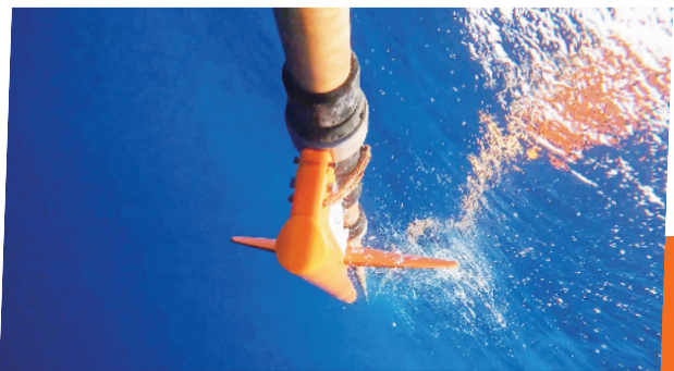
“海经”拖缆定位控制系统正在调节电缆深度。
