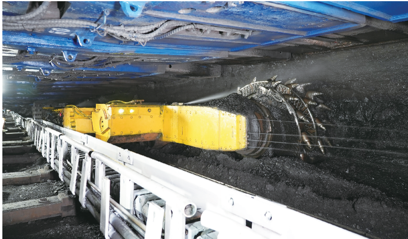
图为国产采煤机在1171(1)薄煤层智能化工作面进行割煤作业。朱集东矿/供图
