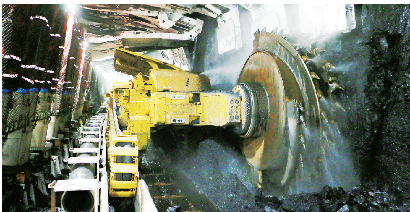
图为中煤陕西公司大海则煤矿井下智能化采煤作业画面。中煤陕西公司/供图
