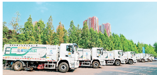
图为濮阳氢能产业发展大会氢能装备展上亮相的氢燃料电池洗扫车。PGO 氢能与燃料电池产业研究院/图
