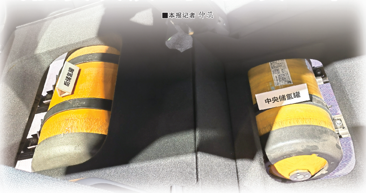
图为丰田汽车公司在2023年上海国际车展上展出的氢燃料电池汽车70兆帕储氢罐。秦淑文/摄
