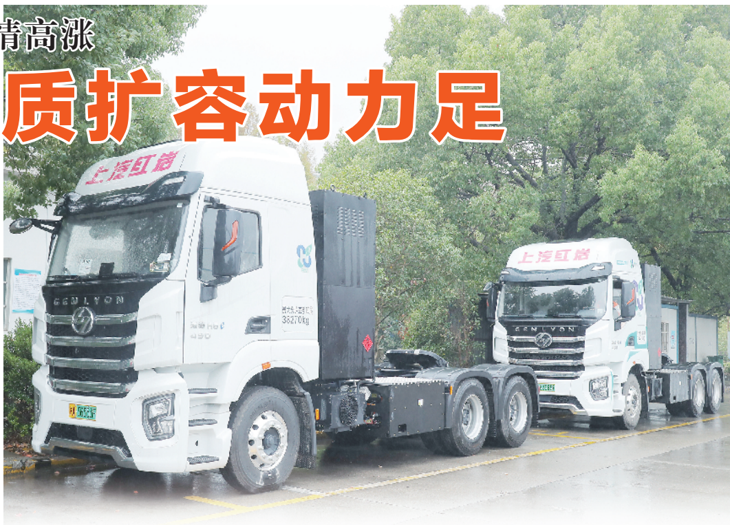
图为装载捷氢科技燃料电池的49吨重卡。捷氢科技/供图
