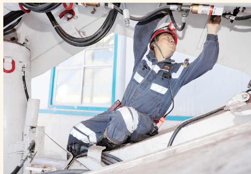
中煤集团中天合创葫芦素煤矿综采队队长抢修液压支架,保障井下煤炭生产。 贺倩/摄
