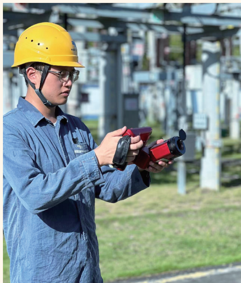
图为南方电网深圳供电局变电管理一所的工作人员正在对辖区重载设备进行测温“诊脉”,密切监视设备运行状况,保障居民用电可靠、清凉度夏。谢佳奇/摄
