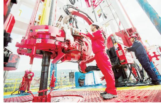
图为中国石油钻井队和相关厂家技术人员对平台上的“铁钻工”进行AI高精度自动识别系统调试。金添 张玥/摄
