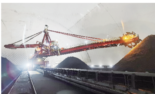
图为浙能乐清发电公司斗轮机通宵堆料提库存。孙超/摄
