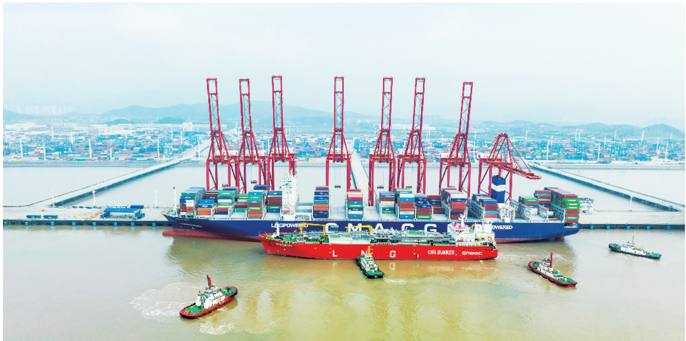
图为6月中旬,海洋石油301船在海事巡逻艇的护航下,缓缓靠向正在码头6号泊位进行装卸作业的双燃料集装箱船“达飞联合”轮执行加注作业。
