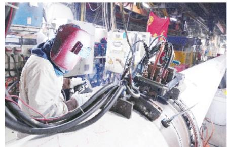
图为施工人员进行自动化焊接作业。韩庆/摄
