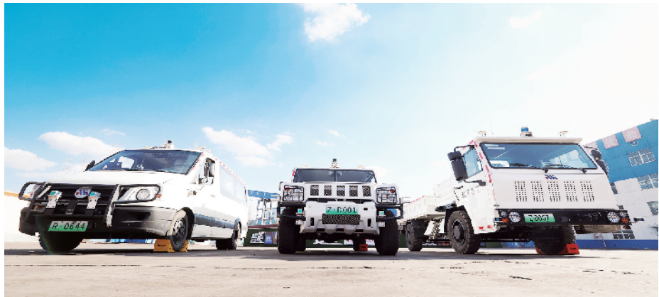
图为在内蒙古鄂尔多斯，无人驾驶车在矿并投运，用于井下人员接送、物料运输等。视觉中国
