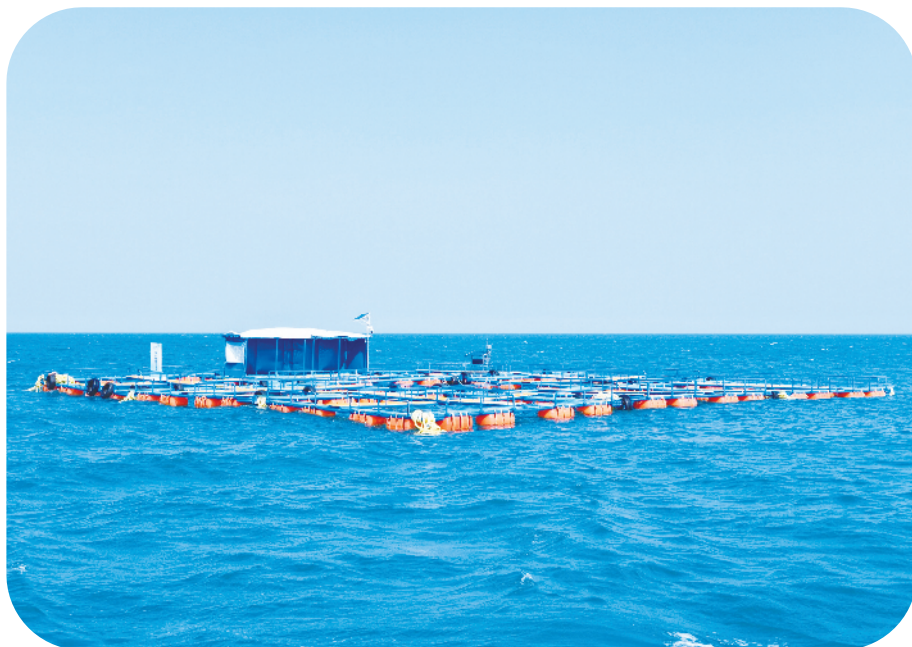
位于海南昌江黎族自治县海域的我国最大海水提铀海试平台。中核集团/供图
