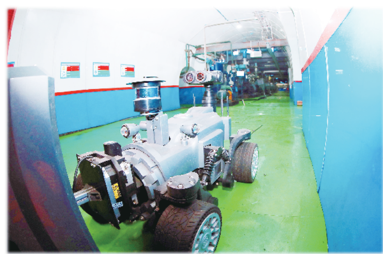
图为应用矿鸿操作系统的巡检机器人正在根据指令自主工作。国家能源集团神东煤炭/供图
