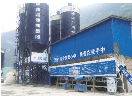
胶结砂砾石专用拌和设备现场拌合
