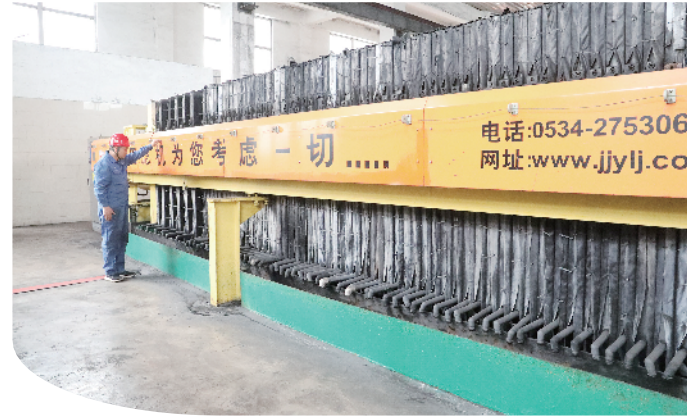
山焦华晋沙曲选煤厂洗水净化车间压滤工正在卸煤泥
