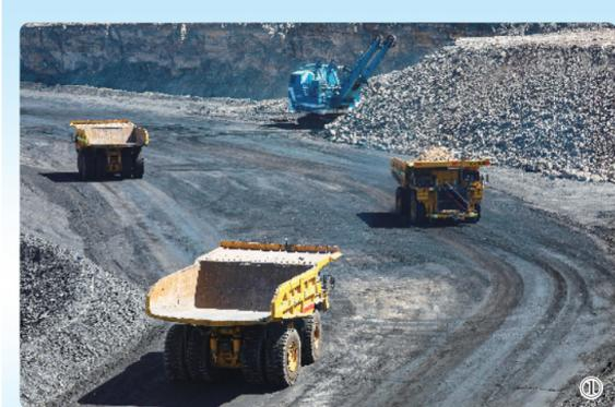
图①②为无人驾驶卡车正在与电铲进行编组作业 图③为智能装车系统进行装车作业
