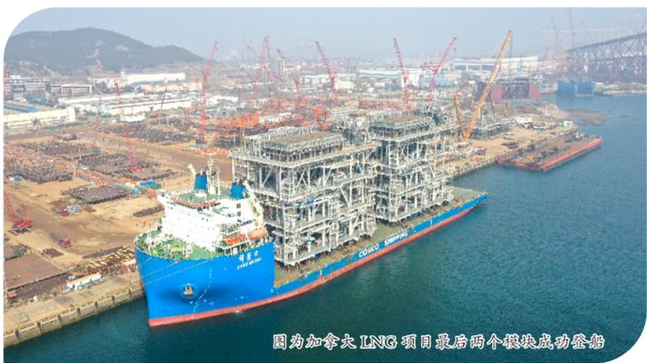
图为加拿大LNG项目最后两个模块成功叠船
