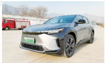
作为SUV,越野能力应是其天然属性。面对试车场的交叉轴、侧坡测试设施,只要控制好车速和方向,bZ4X均可轻松通过。其装备的X-MODE系统注入了斯巴鲁品牌的四驱基因,有雪地/土地、深雪地/泥地、智能蠕行等模式可供选择。
