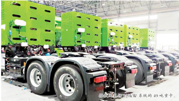
搭载风氢扬120kW系统的49吨重卡。
