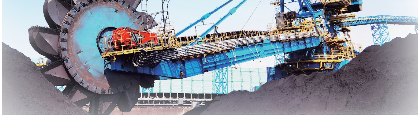
山西焦煤集团日照智能化炼焦煤配煤基地作业现场,取料机正在取料入配煤筒仓,根据客户需求进行定制化生产。易远凤/图
