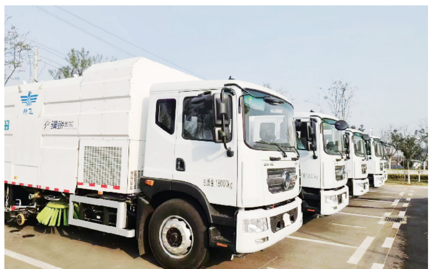
装载骥翀氢能燃料电池产品的氢能环卫车 骥翀氢能/供图
