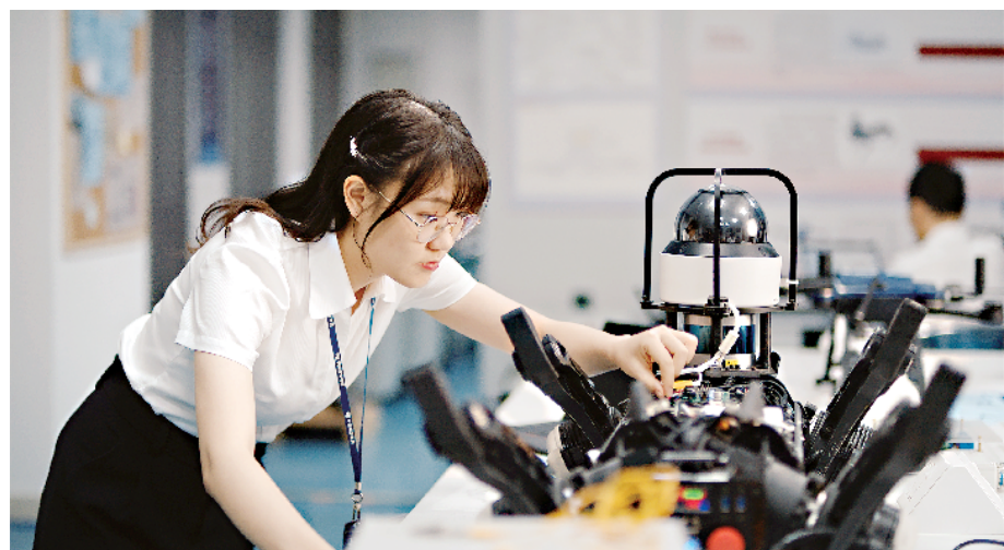
南网数字集团人工智能团队研发的四足智能巡检装置。南网数字集团/供图
