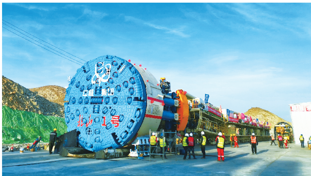
全球首台大坡度螺旋隧道硬岩掘进机——“北山一号”整机。中核集团/供图
