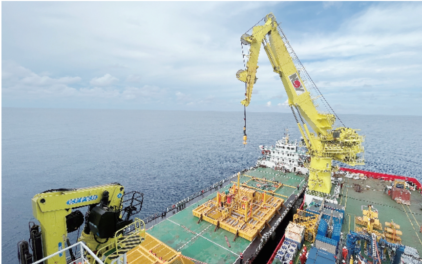
深水水下生产系统的重要组成部分——深水水下管汇,正准备由工程船实施安装。
