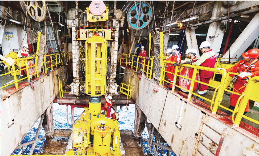
深水水下生产系统的重要组成部分——深水水下采油树,正抵海上钻井平台正在下水安装。
