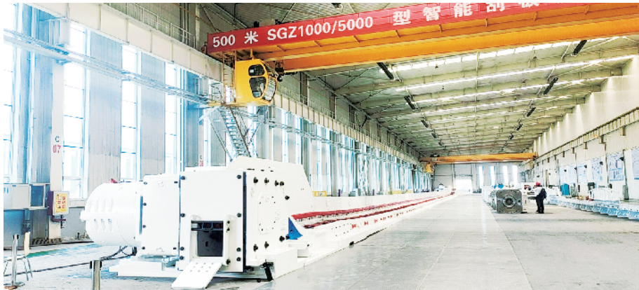
图为国内首台 500 米 SGZ1000/5000 型智能刮板输送机成套装备。中煤张煤机公司/供图
