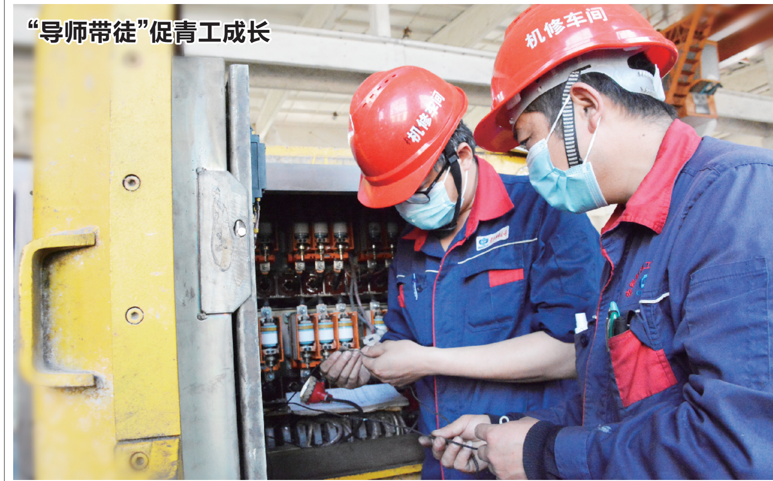
今年以来,中煤新集设备维修公司结合企业实际推行“导师带徒”结对帮扶活动,挑选经验丰富、技艺高超的老师傅与青年职工签订师徒合同,通过检修现场“手把手教学、一对一指点”,有效促进青年职工成长成才,为企业发展增添力量。图为4月21日,该公司电工高级技师(左)手把手指导青工检修八组合开关。(陈海朗/摄)
