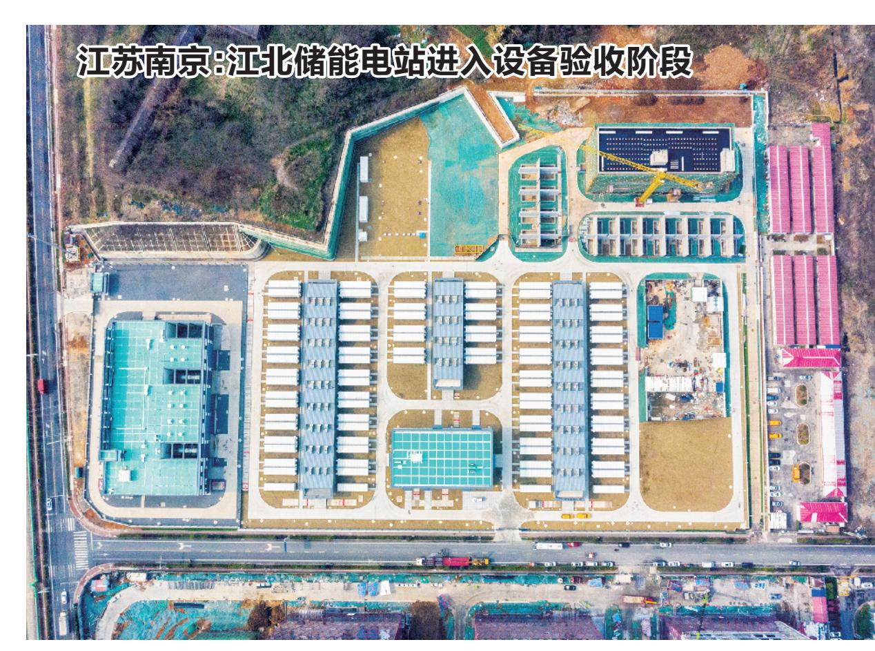
3月1日,江苏省南京市最大的“充电宝”——江北储能电站进入设备验收阶段,预计5月份正式投运。该项目位于江北新区新科十二路,占地51.26亩,最大充放电功率110.88兆瓦,可储存电量约19万千瓦时。储能电站在用电低谷时“插在”电网上充电,在用电高峰时释放电力,可有效填补电力缺口。
