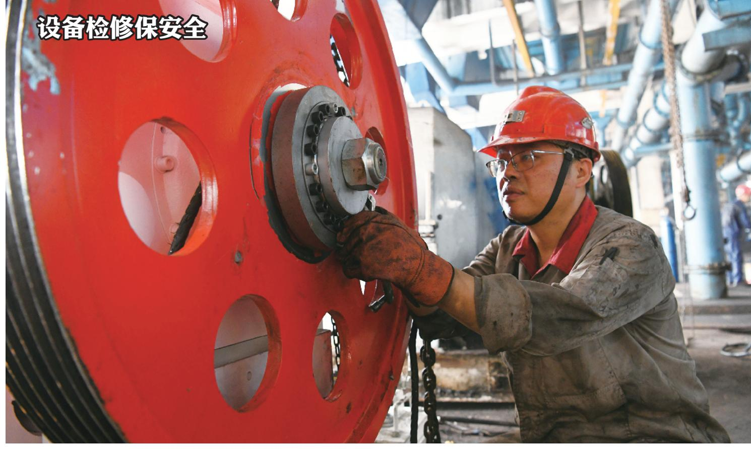
为确保中秋、国庆“两节”生产设备稳定运行,临涣选煤厂加大生产设备动态巡查、检修维护力度。图为9月15日,该厂员工在生产现场检修卧式离心机。
