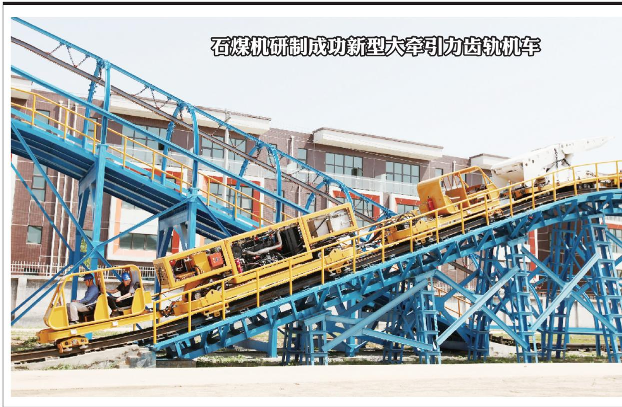
石煤机研制成功新型六牵引力齿轨机车
