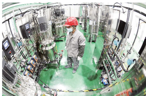
浙能技术研究院牵头组建储能电池初创公司,因为技术人员在萧山电厂对水系锌储能电池进行中试试验。朱将云/摄
