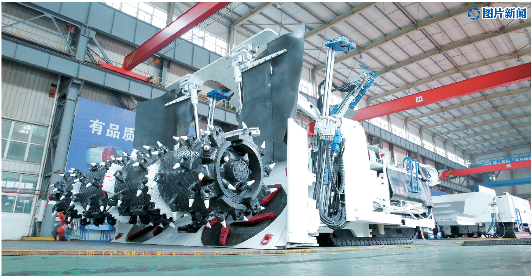
国内首台低矮型半煤岩快速掘锚成套装备下线
