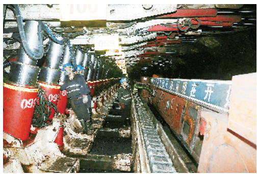
2月14日,华亭煤业集团观北煤矿检修班职工正在检修250208自动化综放工作面设备。
