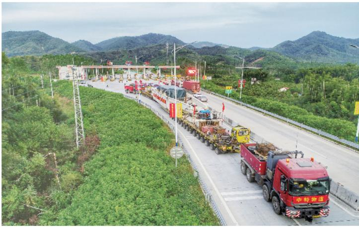
昆柳龙直流龙门换流站首台换流变压器通过大型车运输。南方电网公司/供图
