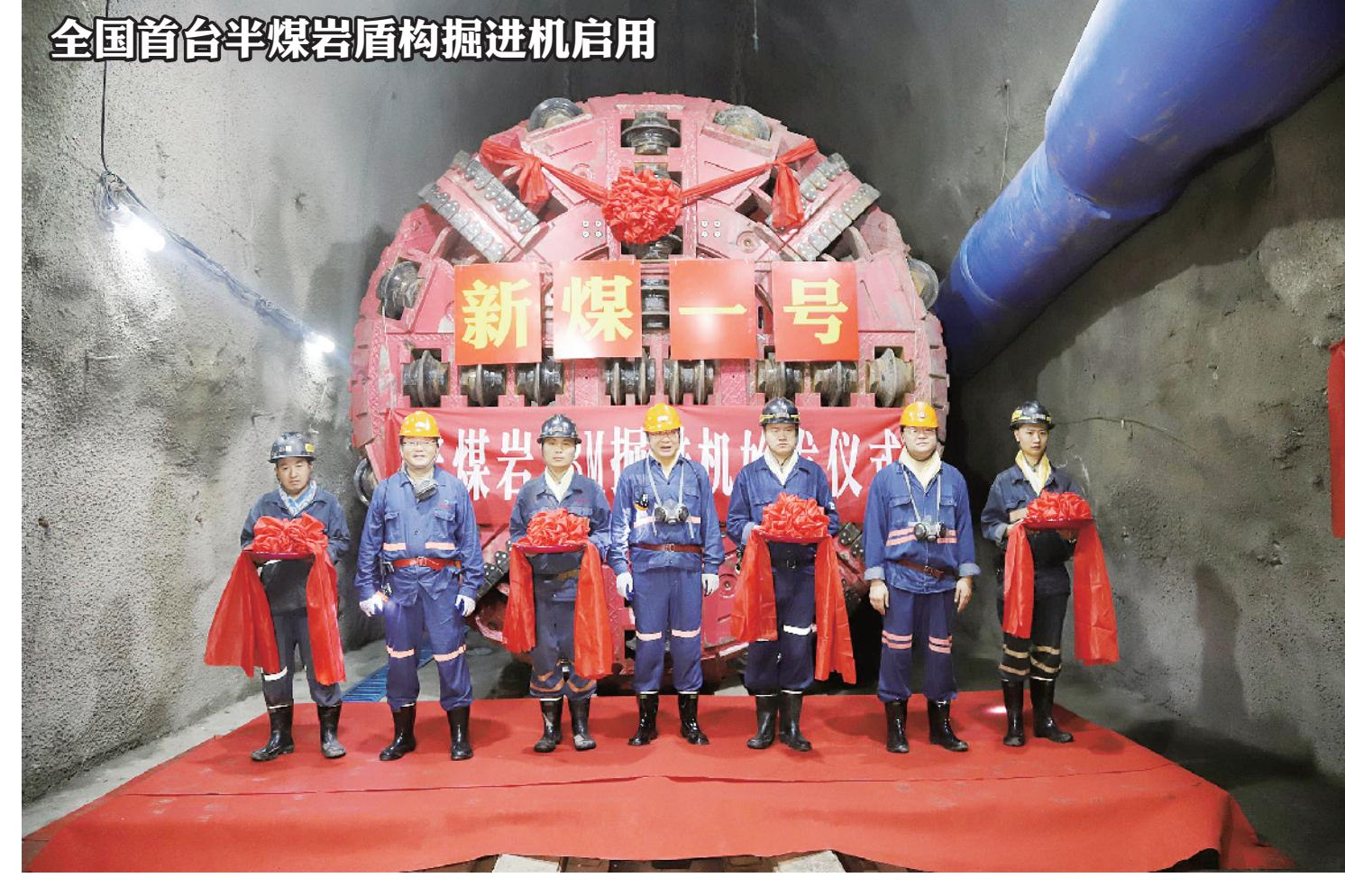
7月1日,全国首台半煤岩TBM全断面掘进机“新煤一号”在山东能源新矿集团翟镇煤矿启用。该掘进机全长60米,刀盘直径4.5米,采用4块式分体复合式刀盘,集掘进、出渣、支护于一体,设计速度为每月500米。
