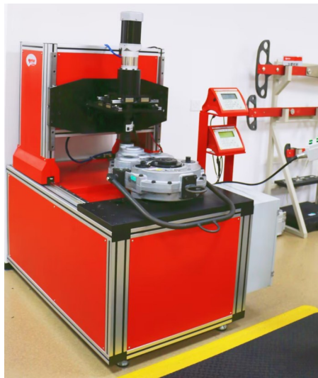
诺霸精密机械(上海)有限公司扭矩校准实验室内配备的,我国目前唯一的航空倍增器扭矩检测装置。
