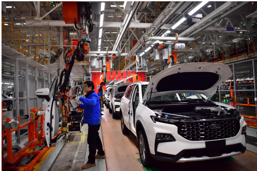
12月25日,江西省南昌市南昌县江铃汽车富山工厂总装车间内,工人们正在安装车门。人民图片
