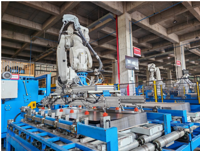
位于永康市的王力安防科技股份有限公司“未来工厂”的门面自动冲压智能生产线，可以使钣金剪冲折一体成形。 胡安华摄
