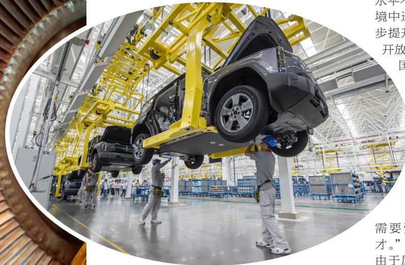
5月23日,安徽省芜湖市奇瑞新能源爱咖生态科技有限公司总装车间内,工人正在进行新能源汽车组装作业。
