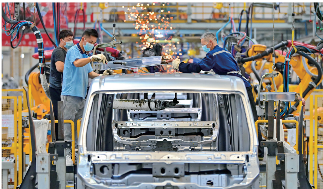
4月9日,江西赣州经开区新能源科技城的一家汽车制造公司内,智能化新能源商用车生产车间一片忙碌,工人在冲焊线上焊装车厢架,产品畅销快递运输行业和南非国家市场。 人民图片
